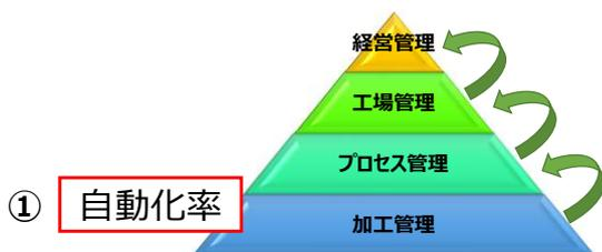
$$\text{自動化率} = \frac{\text{機械加工時間}}{\text{人の労働時間}}$$
